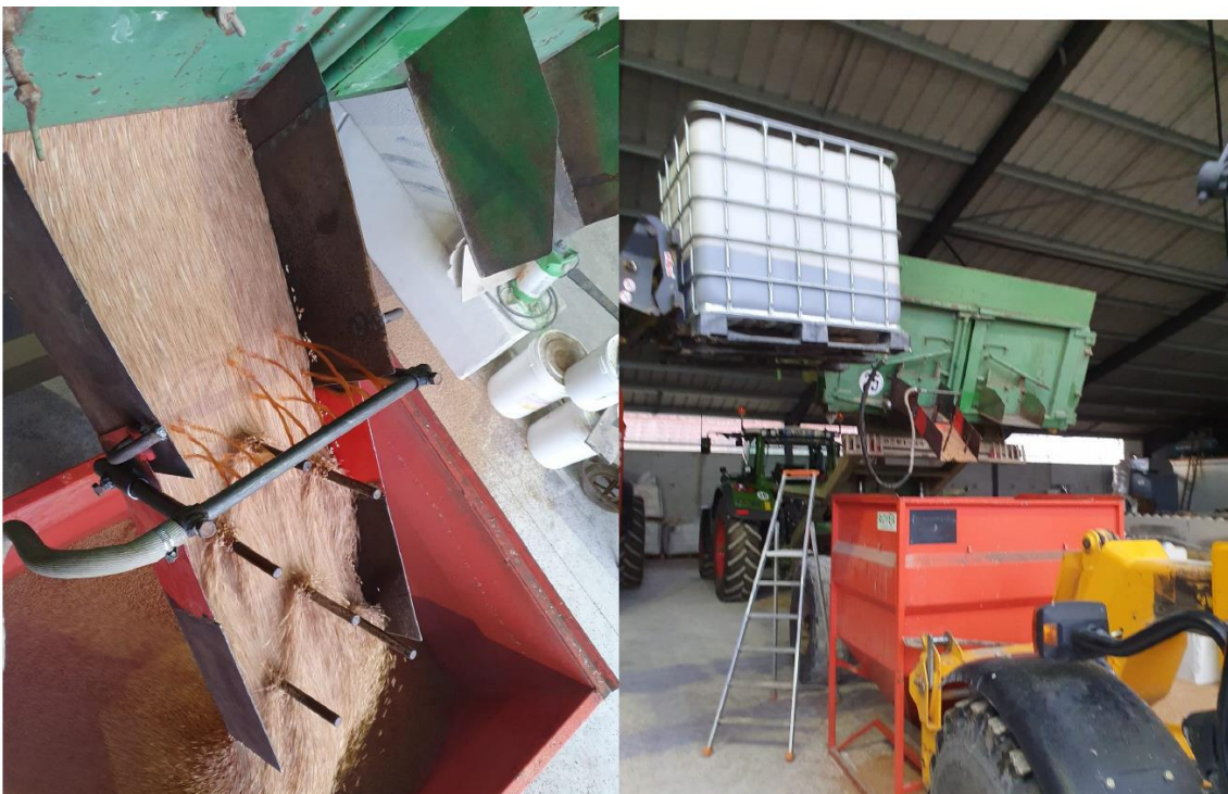
Cuve remplie du mélange, tuyau percé sur la goulotte qui descend dans la benne, avec des pics dans la goulotte pour que le mélange soit bien homogène. Temps : 15 Tonnes de grains traités en 10min..
